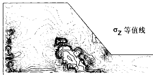
图 6.3-2 (b) 积分点上功能函数均方差等值线图
