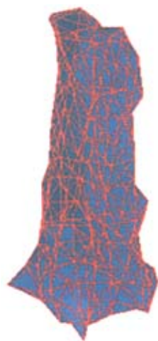
图 5.13 减振器在设定的粒度参数下形成的包络体
