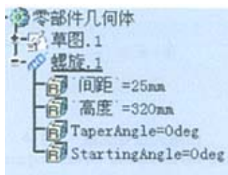
图 4.18 螺旋弹簧的参数化模型中的用户自定义参数
