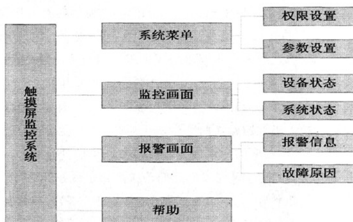
图 5-1 回转布料机触摸屏系统功能图
