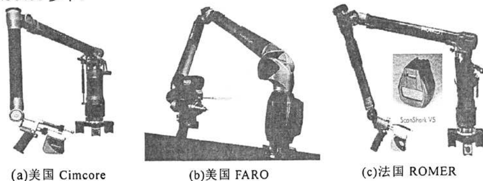
图 3-1 国外柔性三坐标测量机
