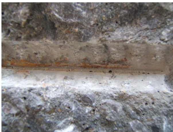
图 3-9 拔出且劈裂破坏的试件的破坏面
