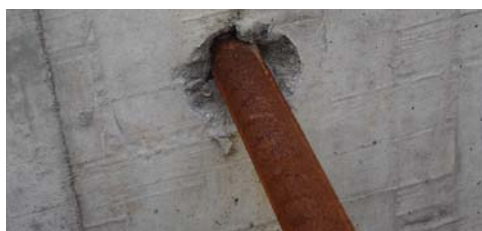
图 4-19 试验时钢筋的锈蚀状态
