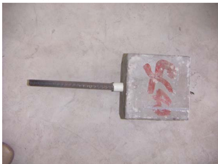
图 3-6 试件的拔出破坏
