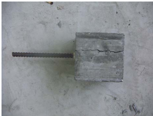
图 3-8 试件的拔出且劈裂破坏
