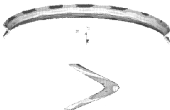
图 5-1 密封圈的模拟结果
