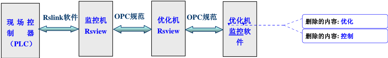
图 5-13 优化软件与现场可编程逻辑控制器数据通信示意图
