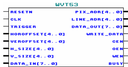
图 5.2 5-3 小波分解模块 (WVT53) 的输入输出接口图
