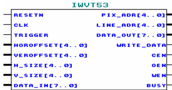
图 5.11 5-3 小波合成模块 (IWVT53) 的输入输出接口图
