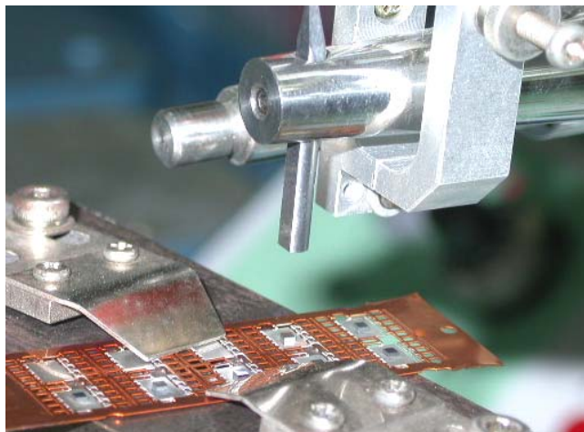
图 2-9 实际倒装试验台的细节
