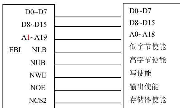
图 3-12 16 位数据总线的连接
