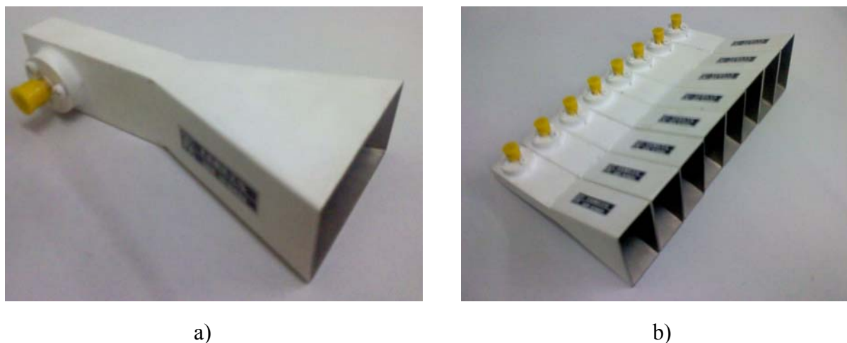
图7-1 a)E 面扇形喇叭; b) E 面扇形喇叭线阵
