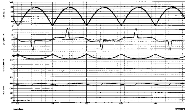
图 5-2 整流线电压，线电流，误差放大器输出（占空比）和储能电容电压。
