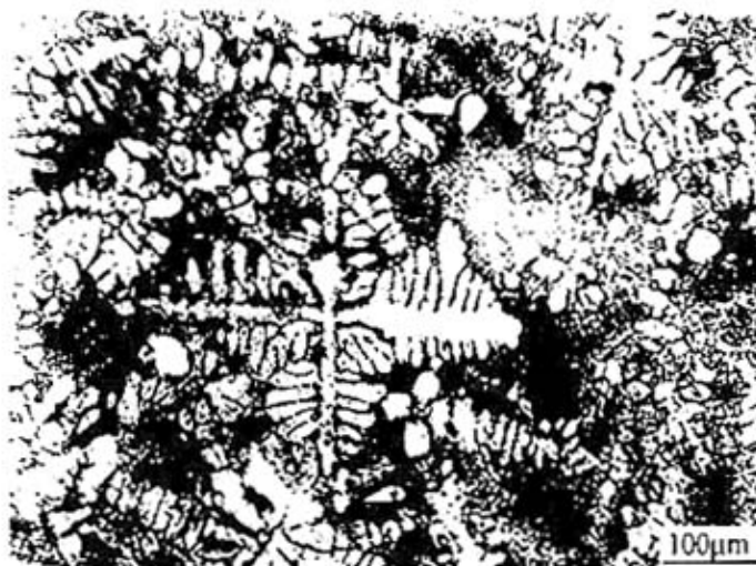
图 5-9 Al-Si 合金铸态下的枝晶 \alpha 组织 [161]
