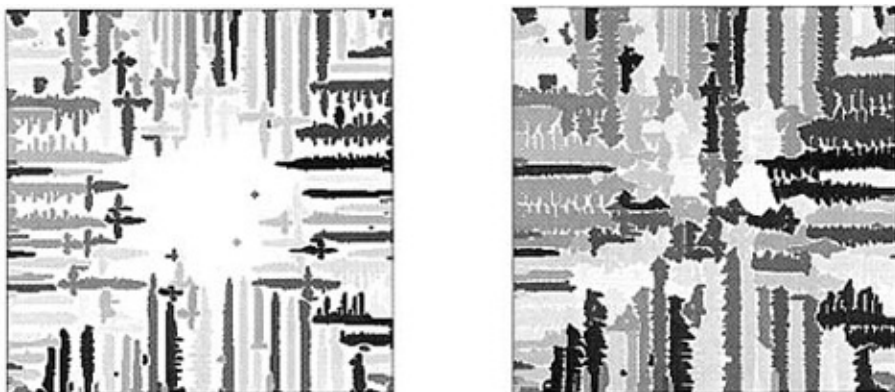
图 6-8 冷却速度 5K/s，温度梯度 10^4\text{K/m} 时的晶粒组织，左图 t=2\text{s} ，右图 t=5\text{s}
