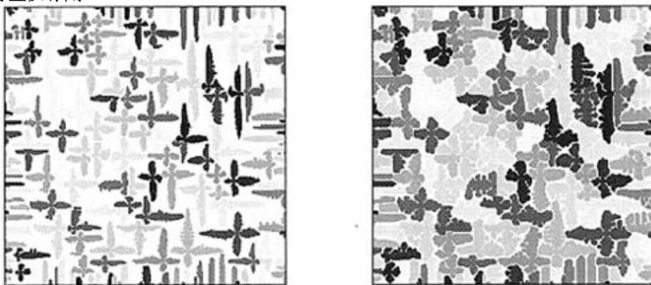
图 6-9 冷却速度 5K/s， n_{\text{max},v}=8.5 \times 10^{10}\text{m}^{-3} ， \Delta T_{N,v}=3\text{K} 时的晶粒组织，左图 t=1.5\text{s} ，右图 t=5\text{s}
