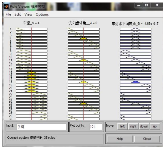
图 5.7 车灯水平偏转模糊控制规则查看器
