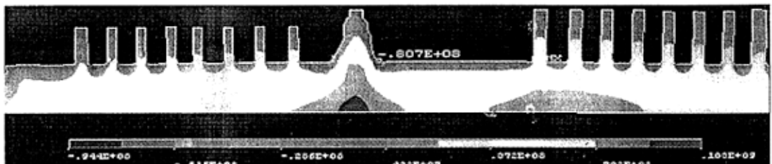
图 3-5-19 启动 90 分钟转子调节级叶轮根部最大径向应力分布
