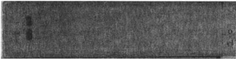
图 4.4 乙酸乙酯/二氯甲烷 (1.35/1.65) 展开体系对美托洛尔的拆分影响
