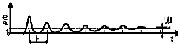
图2-2加性非均匀采样点的概率分布
