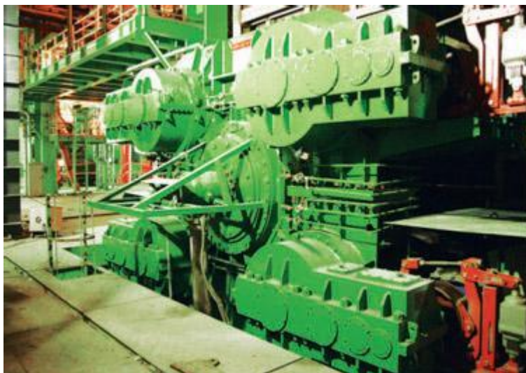
图 2.3 全悬挂式转炉倾动机械分减速机配置形式
