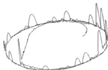
图 6-17 磨筒直径为 300mm 时 介质运动轨迹
