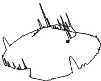
图 6-4 电机转速为 30rad/s 时 介质运动轨迹
