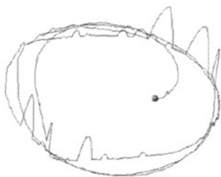
图 6-6 电机转速为 80rad/s 时 介质运动轨迹
