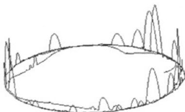
图 6-16 磨筒直径为 200mm 时 介质运动轨迹
