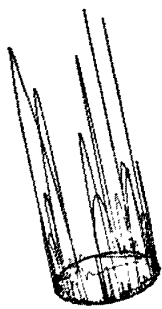
图 6-18 磨筒直径为 200mm 时 介质运动轨迹
