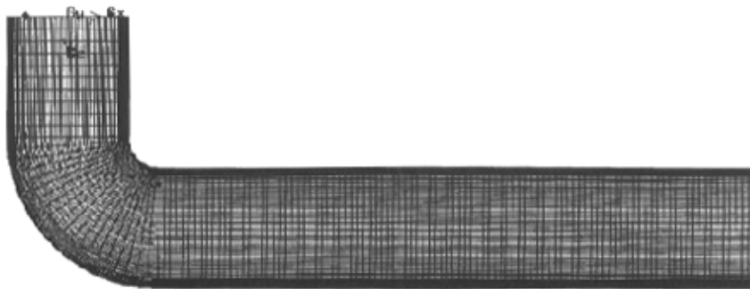
图 3.13 单弯管流动求解区域侧面 (部分)
