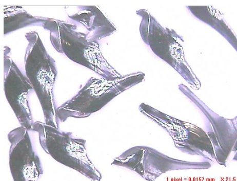
图 3.4 类圆锥蝌蚪型切屑（材料：42CrMo， v_c=130\text{m/min} ， f=0.15\text{mm/r} ）
