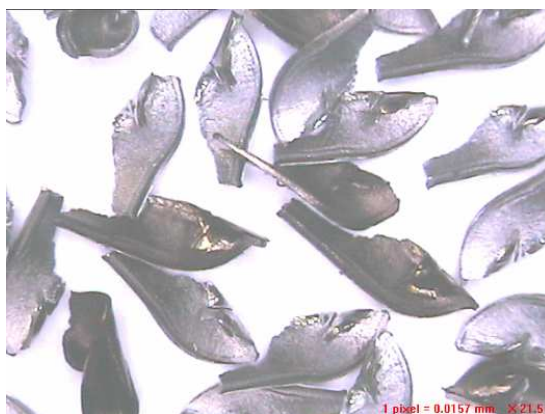
图 4.24 42CrMo 切屑（按第二组参数切削）
