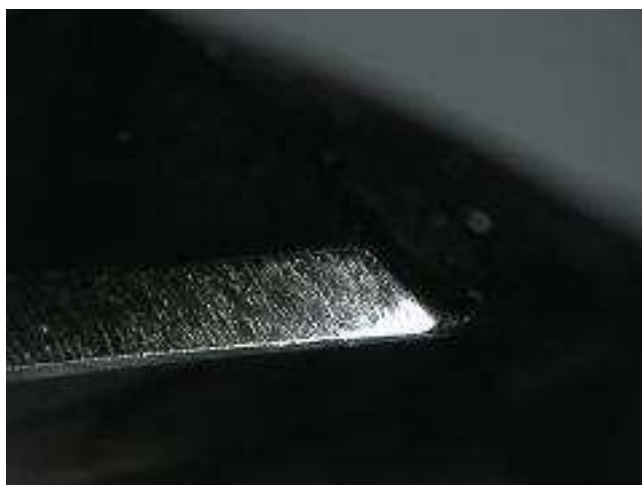
图 4.35 麻花钻边界沟槽磨损
