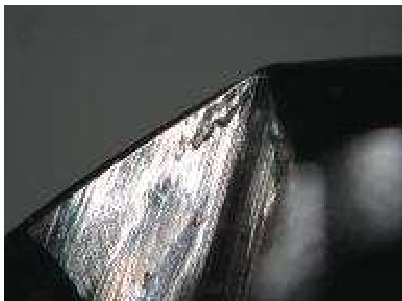
图 4.33 麻花钻前刀面月牙洼磨损
