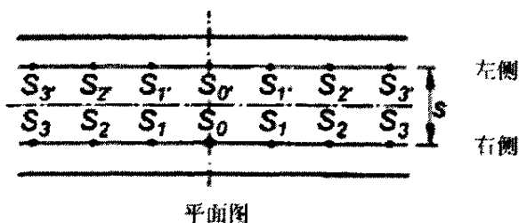
图 4-7 轨枕支承力示意图
