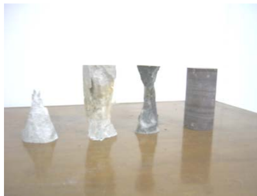
图 3-7 岩石压缩破坏后试件形态
