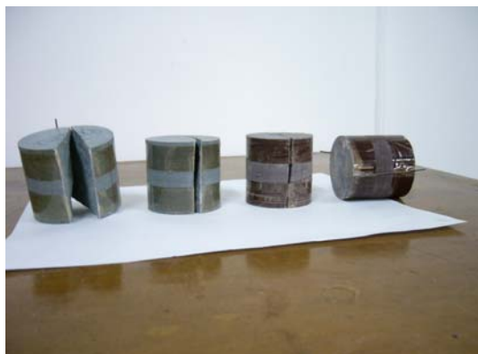
图 3-6 岩石劈裂拉伸后试件形态 2
