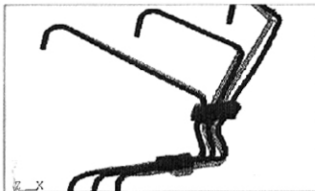
图 6.9 高压油管第五阶模态 Fig. 6.9 The fifth order vibrancy
