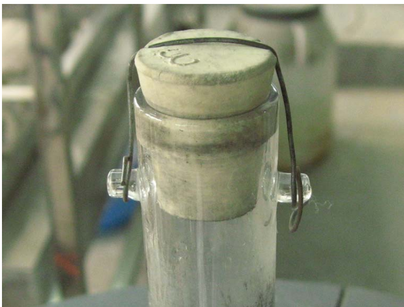
图 2-13 用于固定胶塞的栓
