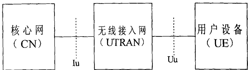
图 2-1 UMTS 网络总体结构
