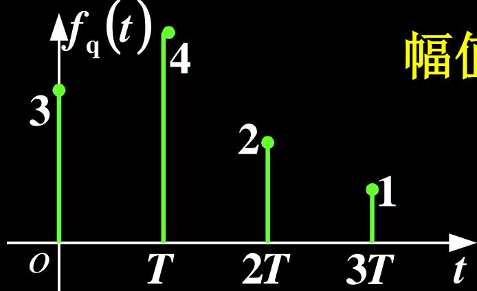
数字信号：离散信号在各离散点的幅值被量化的信号。
