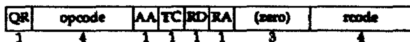
图 2.3 DNS 报文中的标志字段
