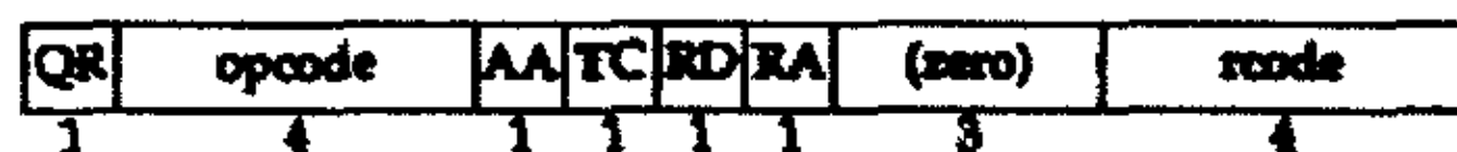
图 2.3 DNS 报文中的标志字段
