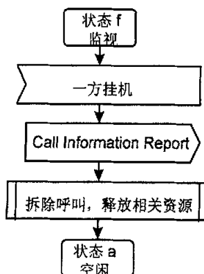
图 5.11 SSF FSM 状态迁移流程图(状态 f→a)
