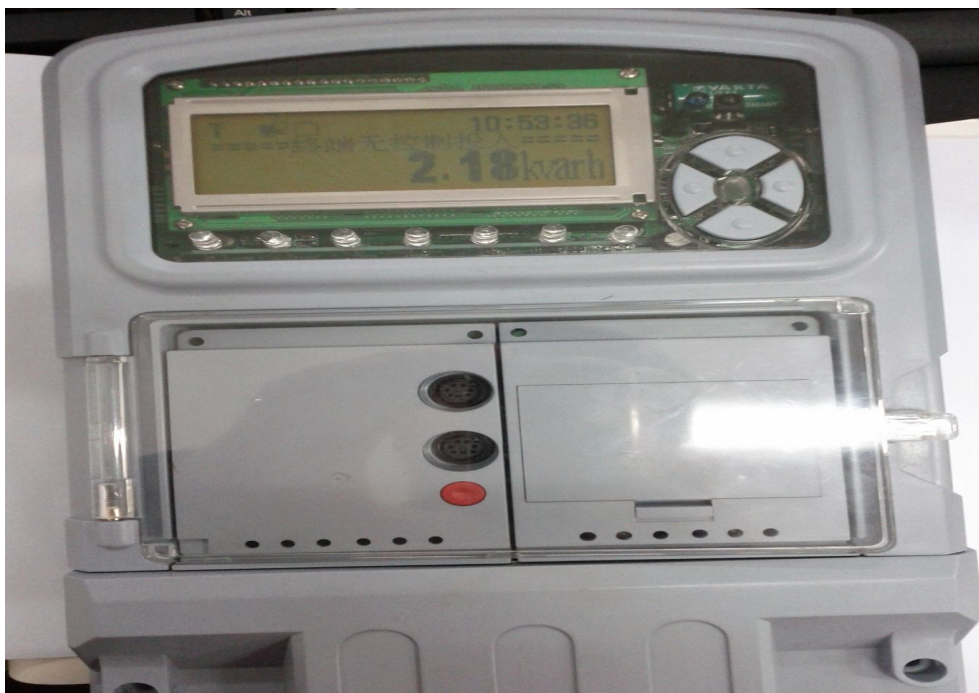
图 6.8 集中器采集到第五个表的电量读数
