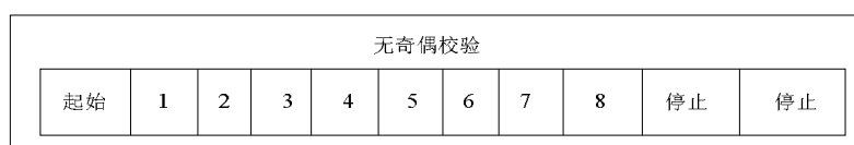
图3.11 RTU模式位序列（无校验的特殊情况）
