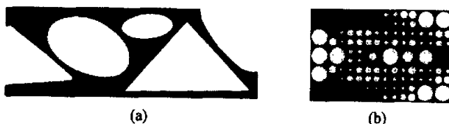
图 4.9 文献结果: (a) 基于特征的设计 [49] , (b) 基于有限尺度特征的优化 [50]
