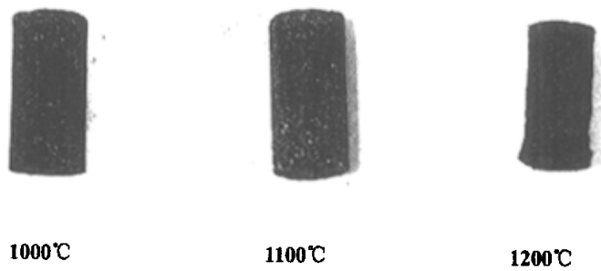
图 4-14a \text{SiO}_2 含量为 0 的模拟灰在不同温度加热下的灰柱
