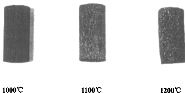
图 4-22a \text{Na}_2\text{O} 含量为 0 的模拟灰在不同温度加热下的灰柱
