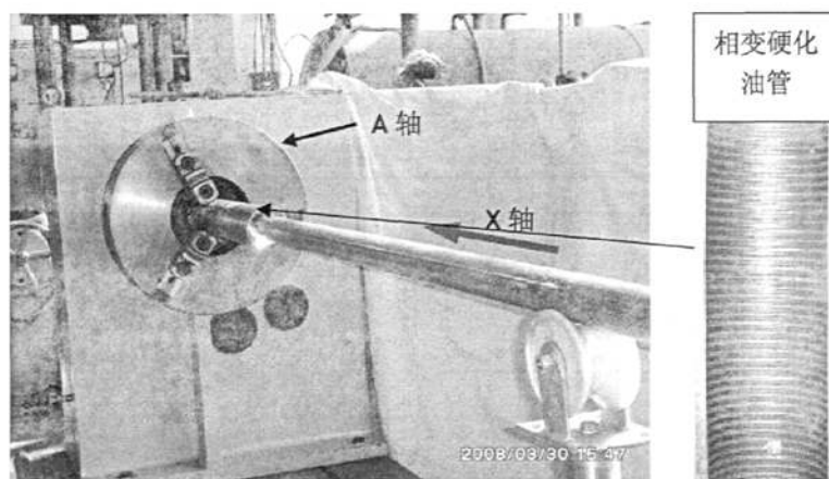
图 3-3 油管内壁激光加工示意图及相变硬化油管
