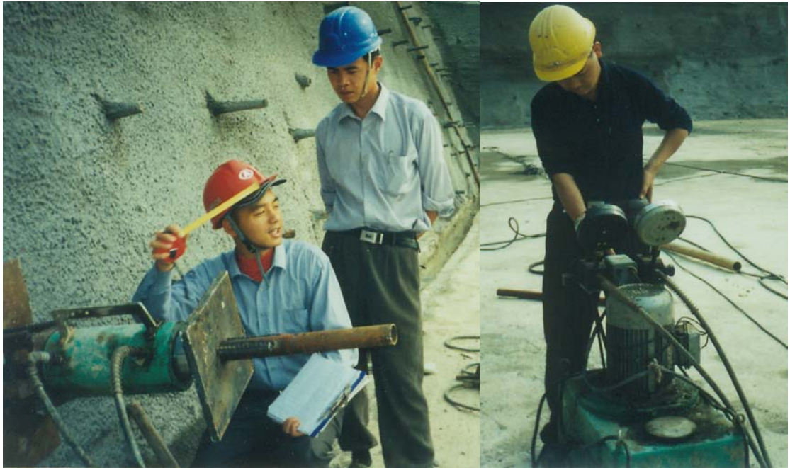
图 2-9 现场抗拔力试验
