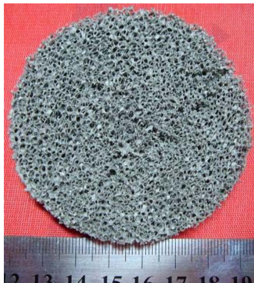
图 4-12 烧结温度过高产生缺陷示意图
