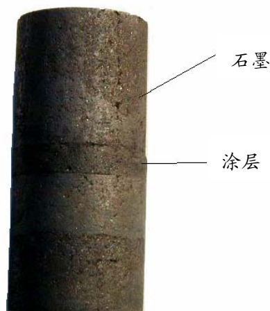
图3-2 \text{TiB}_2 涂层电阻率测试试样
