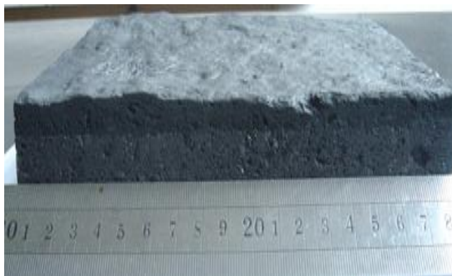
图5-1 高温炭化后的大厚度TiB 2 涂层阴极材料
