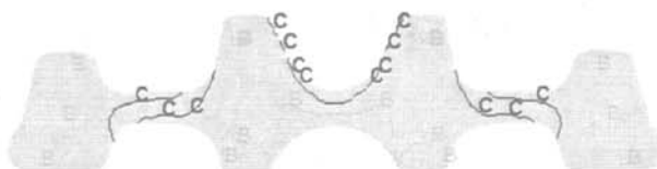
(f) 轮毂充填完全时等效应变图
