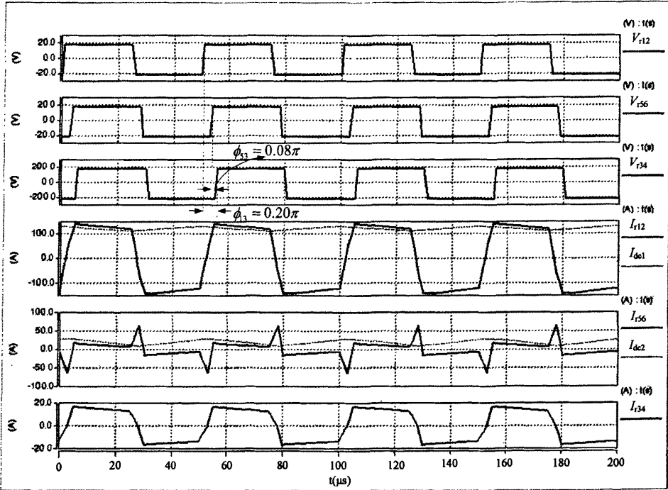
图 3.14 三半桥 DC/DC 变换器在 Boost 模式的稳态工作仿真波形
