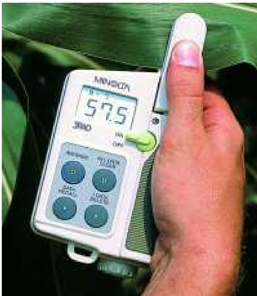
图 3-3 美能达 SPAD-502 叶绿素测量仪 Fig3-3 Minolta Chlorophyll SPAD-502
