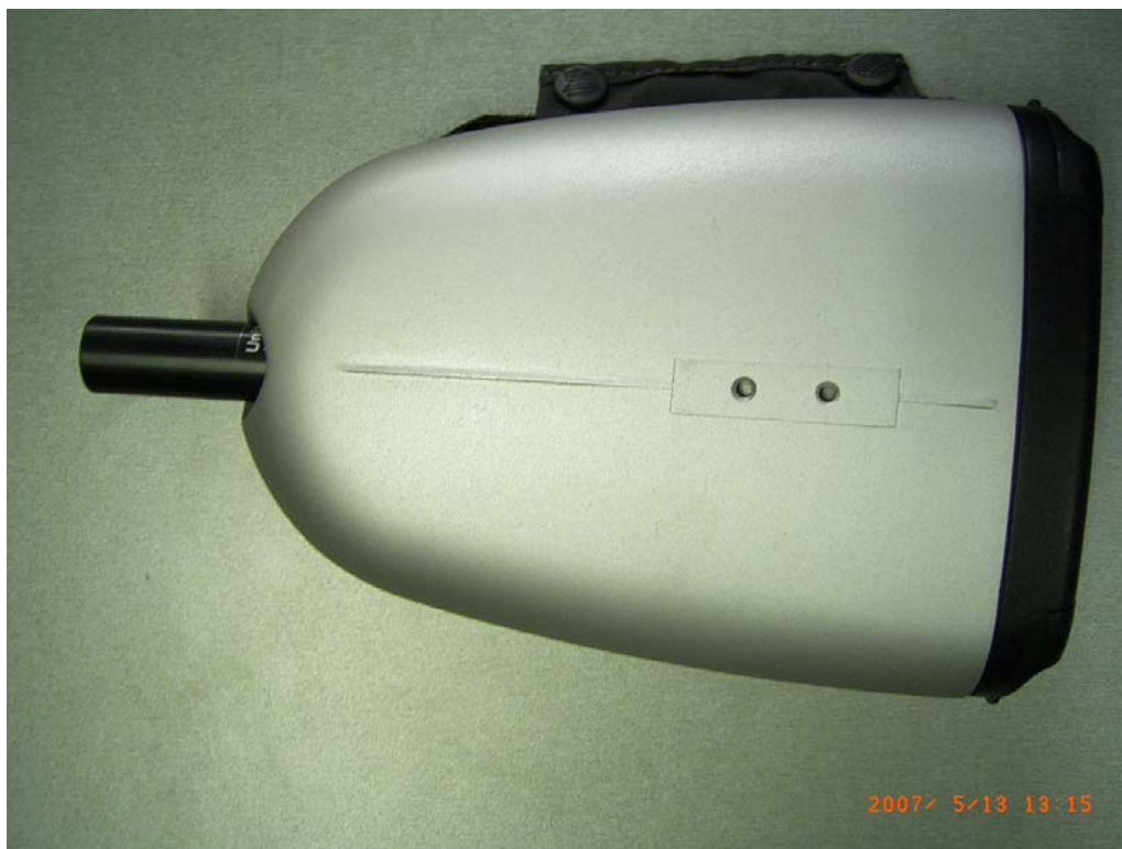
图 3-2 ASD FieldSpec 野外便携式高光谱仪
