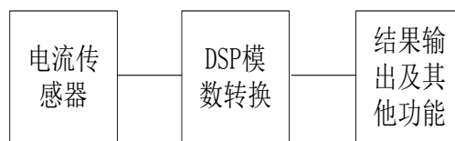
图 3.2 雷电流自动监测系统工作原理图
