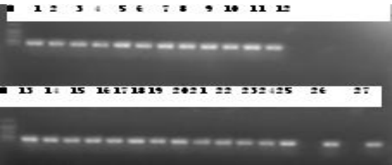
图2.4 引物SS01在27个品系间的1%琼脂糖凝胶电泳图谱
