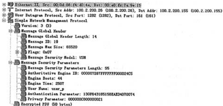
图 6-4(c) 网管工作站发送的 SNMP Get 消息
