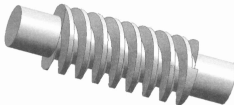
图 10 蜗杆三维模型(此蜗杆头数为 2)
