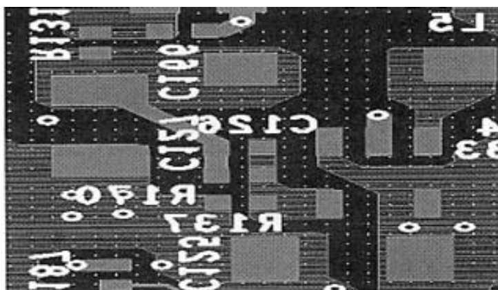
图 4-4 开关稳压电路的 PCB 布局设计
