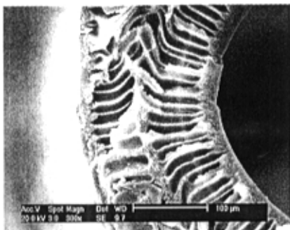
图 3-25 均苯三甲酰氯体系脱盐率为 71.8%，通量为 8\text{L}/\text{m}^2\text{h} 的中空纤维复合纳滤膜微观结构
