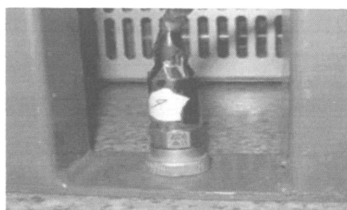
图 8.2 压电式加速度传感器
