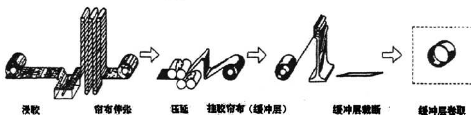
图 1.6 长纤维（帘布）增强型缓冲层制备过程示意图
