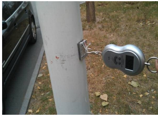
图 5-16 吸附单元吸附力测试。
