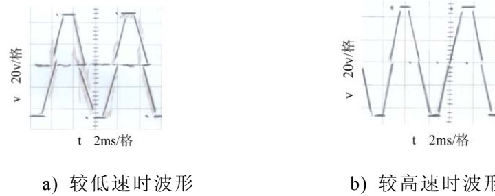
图 5.8 高速时 A 相电压波形图
