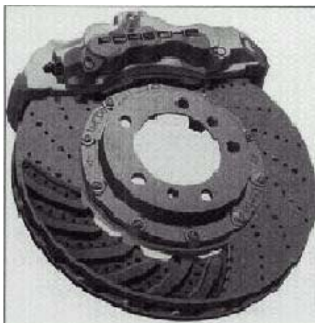
图 1-1 盘式制动器结构
