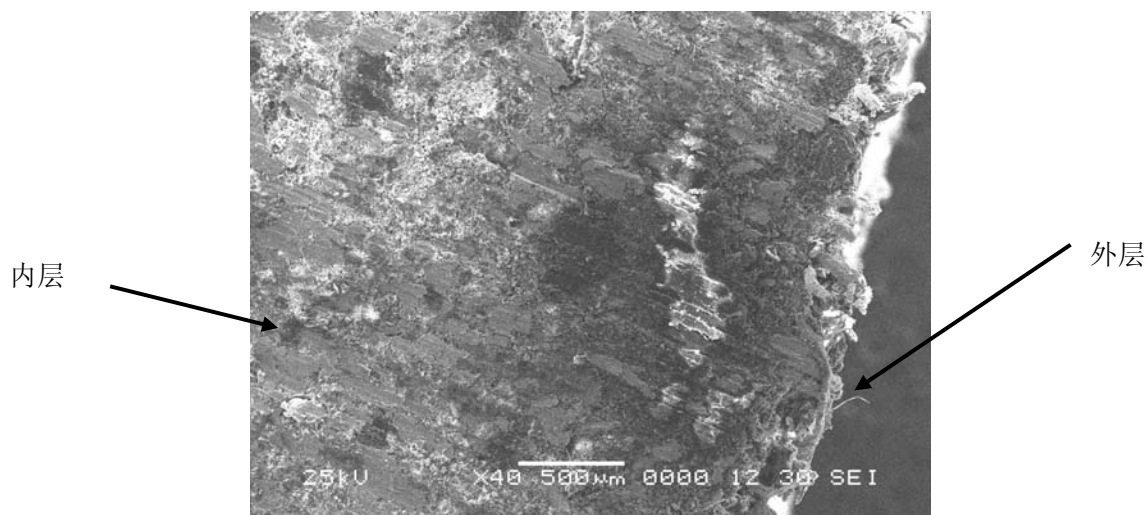
图 4-23 服役后摩擦材料纵剖面扫描电镜图象
